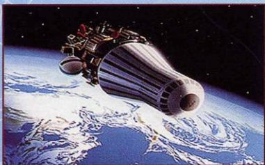
вращаемая капсула предназначена для размещения научной аппаратуры и доставки ее на Землю после выполнения программы исследований.
