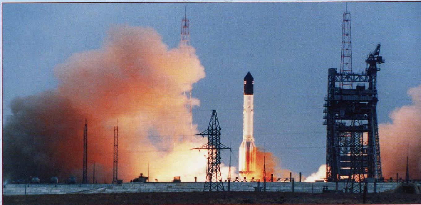
**Н**есобходимо отметить, что «Протон» способен доставлять полезный груз непосредственно на геостационарную орбиту в заданную точку с точностью  $\pm 12$  угловых минут по наклонению и  $\pm 250$  секунд по периоду обращения, что позволяет выводить спутники, не оснащенные апогейным двигательным модулем. Для спутников, имеющих апогейные двигательные модули, масса может быть увеличена.
